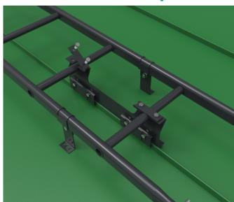
Центральное крепление лестницы фиксируется болтами на двух ступенях. Далее фальц зажимается между ним и контрпластинами. Кровельные кронштейны в этом случае используются в качестве подпорки и к кровельному покрытию не крепятся.
