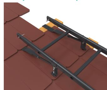
Кронштейн для черепичной кровли закрепляется с одной стороны к дополнительной доске обрешетки, а с противоположной к кровельному кронштейну, который никак не крепится к кровельному покрытию, используется в качестве подпорки.
