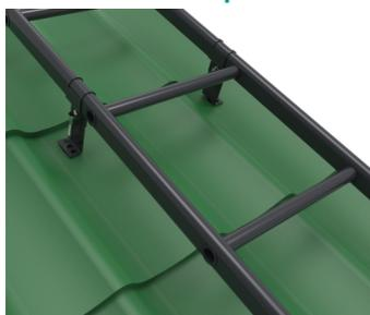
Кровельный кронштейн крепится через покрытие к обрешетке шурупами 8\*50 мм через уплотнитель. После установки затянуть болт, фиксирующий кронштейн на тетиве.
