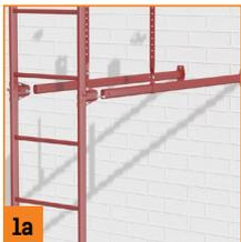
Соединение лестницы со стеновым кронштейном
