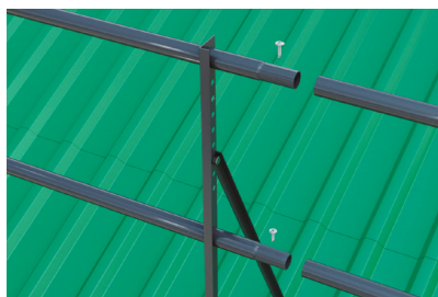
Рис.5 Горизонтальные трубы обжаты с одной стороны, для соединения в одну линию. Фиксацию соединения произвести с помощью саморезов.
