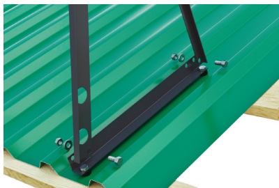
Рис.2 На основание закрепить стойку ограждения и подкос, используя болт М8х20. Соединить их между собой таким образом, чтобы стойка была перпендикулярна плоскости земли.
